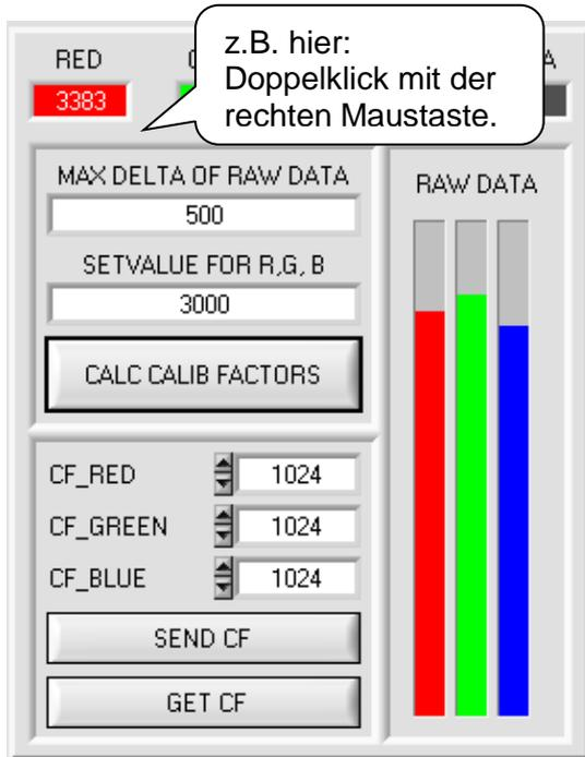
Um zur Offsetkalibrierung zu gelangen, muss in der Registerkarte **CALIBRATE** ein Doppelklick mit der rechten Maustaste irgendwo zwischen den einzelnen Elementen durchgeführt werden
