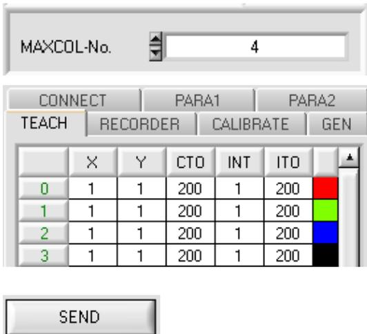
In diesem Beispiel wurde **MAXCOL-No.** = 4 ausgewählt, d.h., der Sensor soll die Farbinformationen wieder finden, welche in den ersten 4 Zeilen der **TEACH TABLE** durch externes Lernen über IN0 abgespeichert werden. Da sich der Sensor seine Toleranzen für den Farbkreis (**CTO**) und die Intensität (**ITO**) nicht selber berechnen kann, müssen diese Werte einmalig eingegeben werden (hier überall 200) und zusammen mit der **MAXCOL-No.** sowie **EXTEACH = ON** im **EEPROM** abgespeichert werden.
