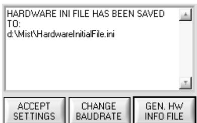
Über den Button **GEN. HW INFO FILE** wird ein File erzeugt, in dem alle wichtigen Sensordaten verschlüsselt hinterlegt werden.
