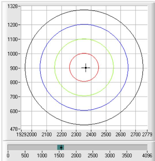
**Tipp!** Dieser Modus findet seine Anwendung, wenn nur eine Farbe eingelernt wird und diese gegen „wegdriften“ kontrolliert werden muss. Durch die aufsteigenden Toleranzfenster kann man dies sehr gut detektieren und eventuelle Gegenmaßnahmen einleiten.
