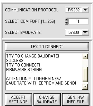
Nachdem die neue Baudrate erfolgreich übertragen worden ist arbeitet der Sensor mit der neuen Baudrate. Außerdem erscheint im Anzeigefenster eine Aufforderung **EEPROM** zu selektieren und anschließend **SEND** zur drücken. Erst nach Drücken von **EEPROM** und **SEND** wird bei einem Hardware-Reset mit der neuen Baudrate gestartet.
